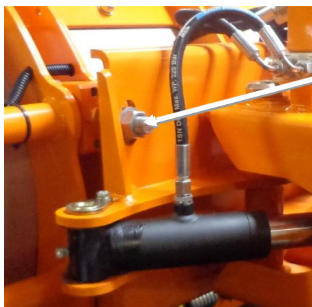
Bild 8: Einstellen des Auflegewinkels - Stellschraube
