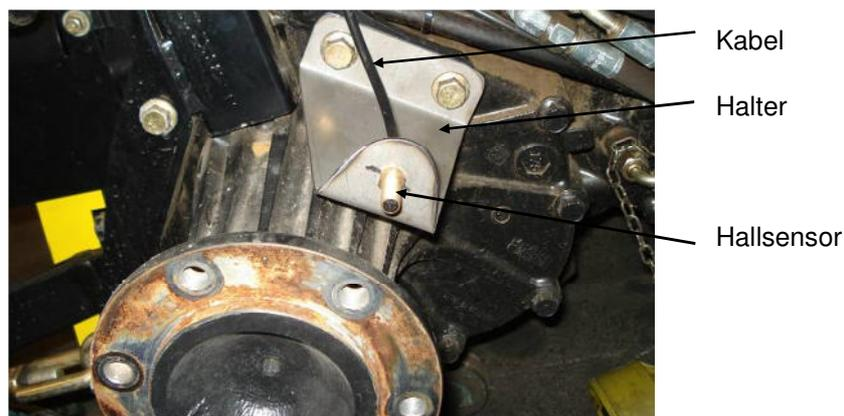
Bild 2 Halterung für den Hallsensor. Beispiel.
