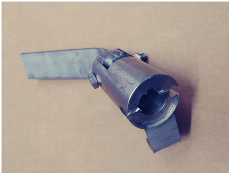
Bild 4: Rührwerk für grobe Körnung
