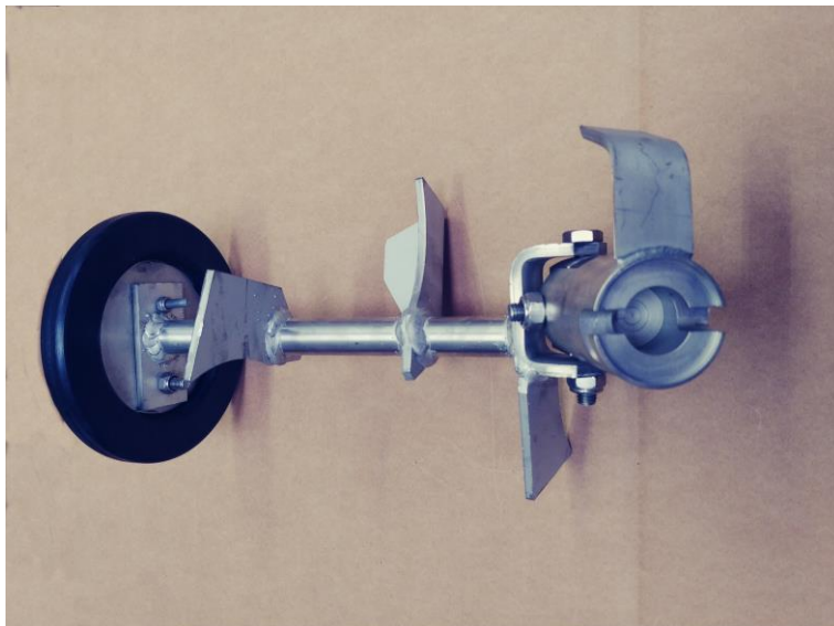
Bild 5: Rührwerk für Sand und Salz
