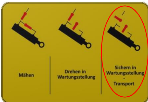
Abbildung 36: Pos. Der Absperrhähne „Sicherung in Wartungsstellung“
