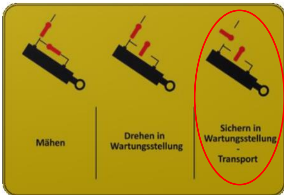
Abbildung 36: Pos. Der Absperrhähne „Sicherung in Wartungsstellung“
