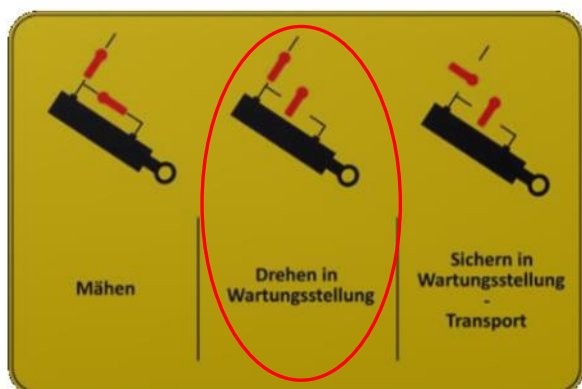
Abbildung 33: Pos. Der Absperrhähne „Drehen in Wartungsstellung“
