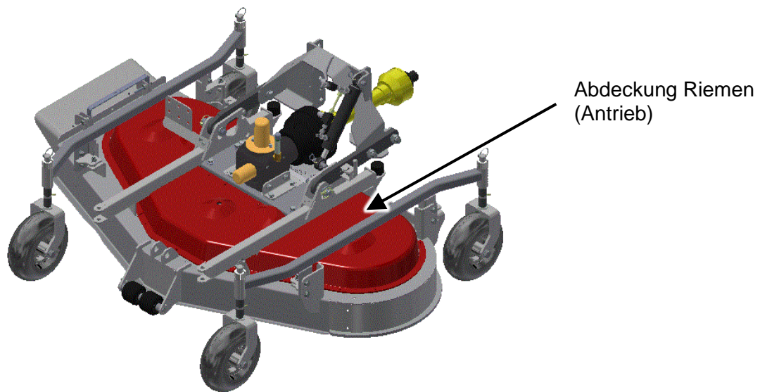
Abbildung 4: Abdeckung Riemen (Antrieb)
