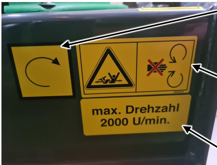
Abbildung 14: Warnbildzeichen auf Grunddeck (rechts Seitenauswurf hinten)
